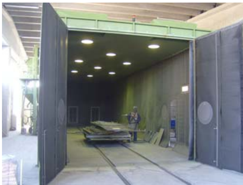
Esempio di cabina di cella di sabbiatura con rotaie per i carrelli
