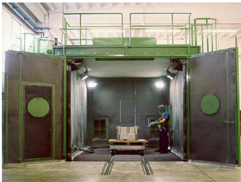
Esempio di sabbiaitura di pezzi disposti su carrello
