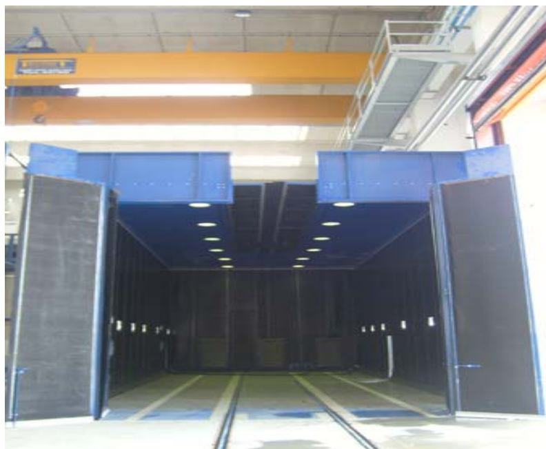
Esempio di cabina di sabbiaitura con accesso sia frontale che superiore per il carro ponte
