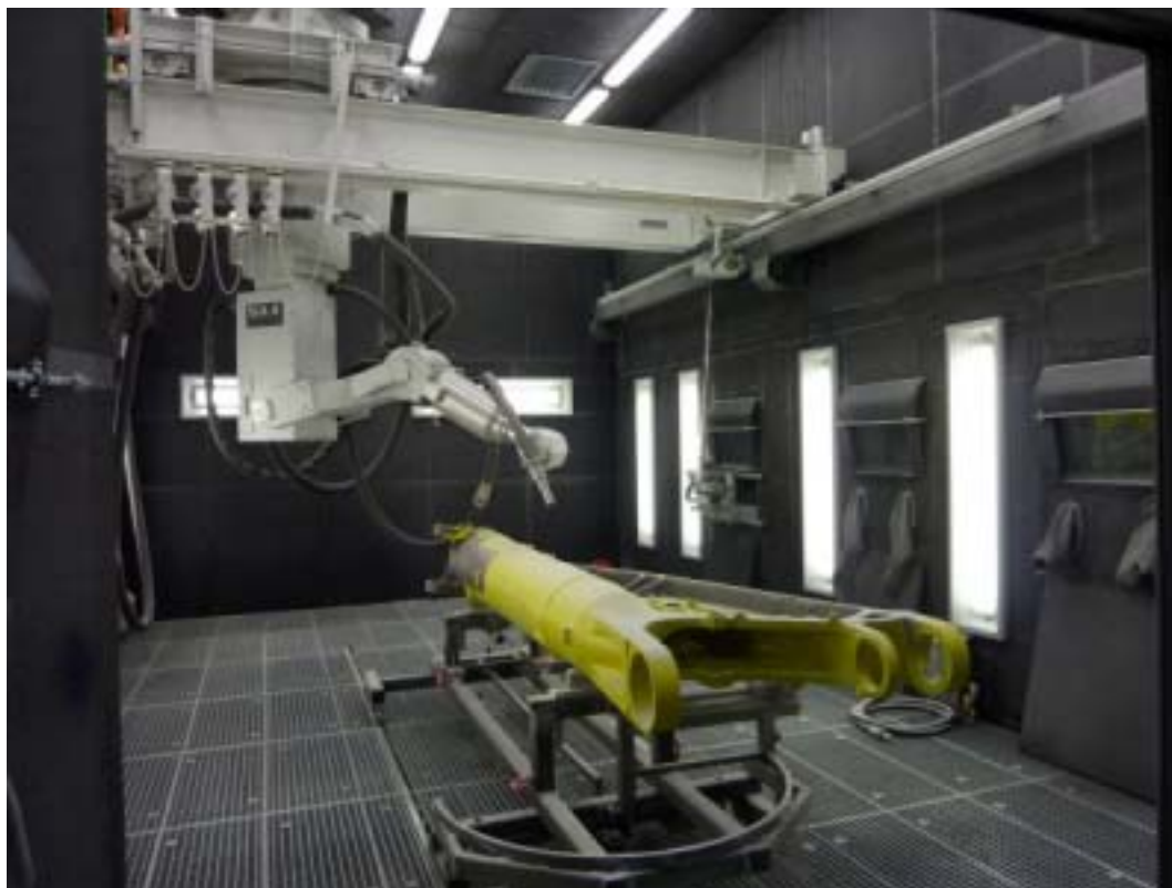
Esempio di braccio robotizzato di sabbiatura durante il funzionamento
